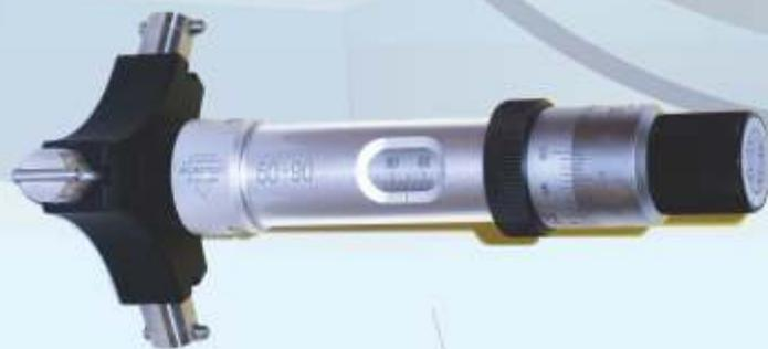
Высокоточное механическое оборудование MICROTEST® может быть дополнительно усовершенствовано электроникой уровня Hi-Tec. Благодаря интенсивному совершенствованию теперь доступными стали цифровые модули, обеспечивающие еще большую точность по сравнению с аналоговыми инструментами. На укомплектованном двумя подшипниками измерительном валу закреплен высокоточный датчик (10 000 инкрементов на оборот). Сбор измерительной информации с шагом 100 нм значительно увеличивает точность.
